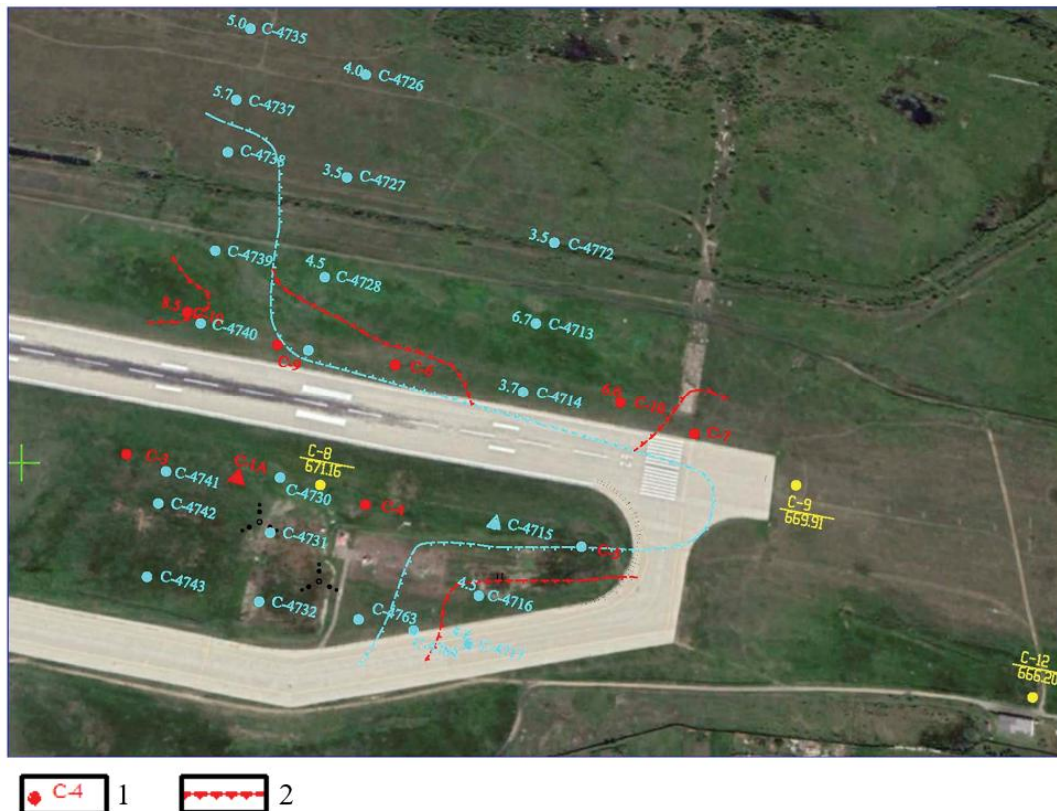
Рис. 4. Схема распространения многолетнемерзлых пород в районе участка, подверженного подтоплению в различные годы (1975, 1982, 2015) / Fig. 4. Scheme of permafrost distribution in the area of the site subjected to flooding in different years (1975, 1982, 2015): 1 – инженерно-геологическая скважина и ее номер; 2 – граница распространения многолетнемерзлых пород
